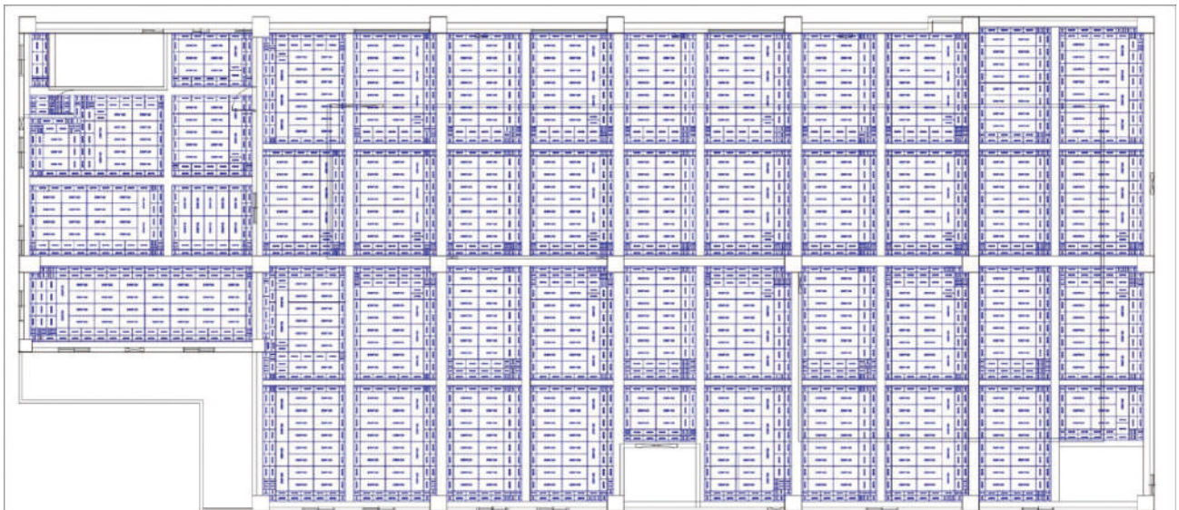
●「Alfa Safe系統模板工法」依相關建築圖說及結構圖說之位置尺寸規劃系統模板之平面配置圖(梁、版)。
